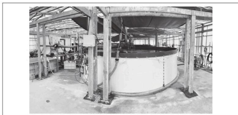
〔図1-6〕 閉鎖循環式陸上養殖システムの一例 (中城村養殖技術研究センター NAICeにて撮影)
