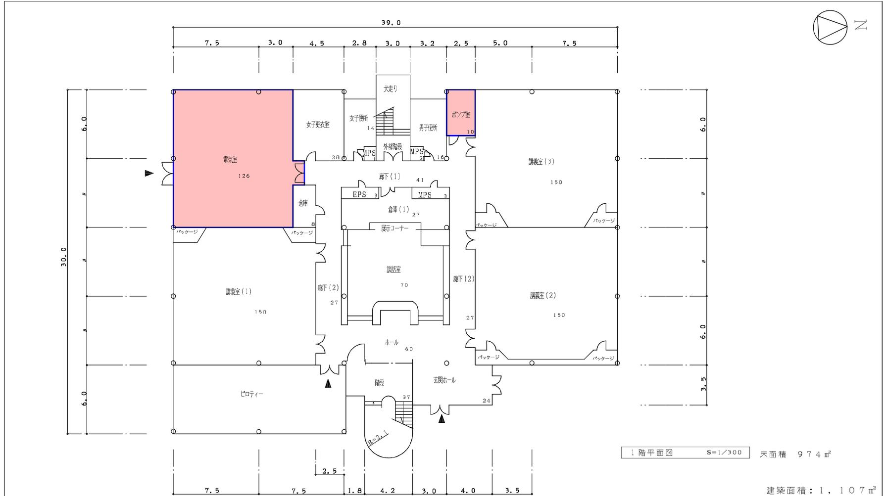
1階平面図 S=1/300 床面積 974㎡
