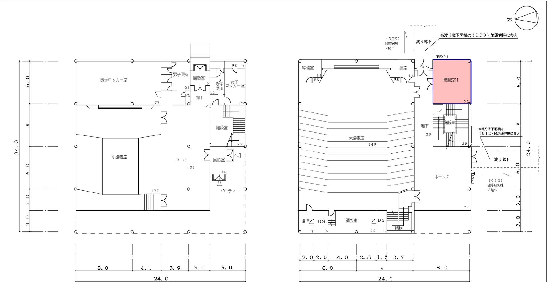
1階平面図 S=1/300 床面積 467㎡
