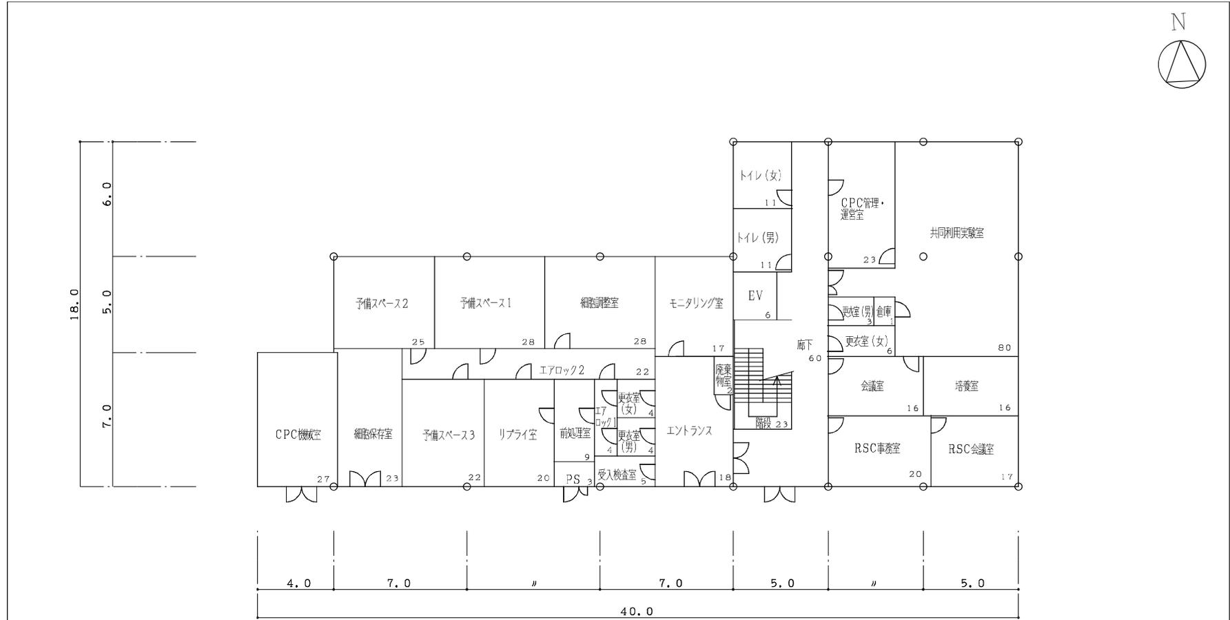
1階平面図 S=1/250 床面積 554 m<sup>2</sup>
