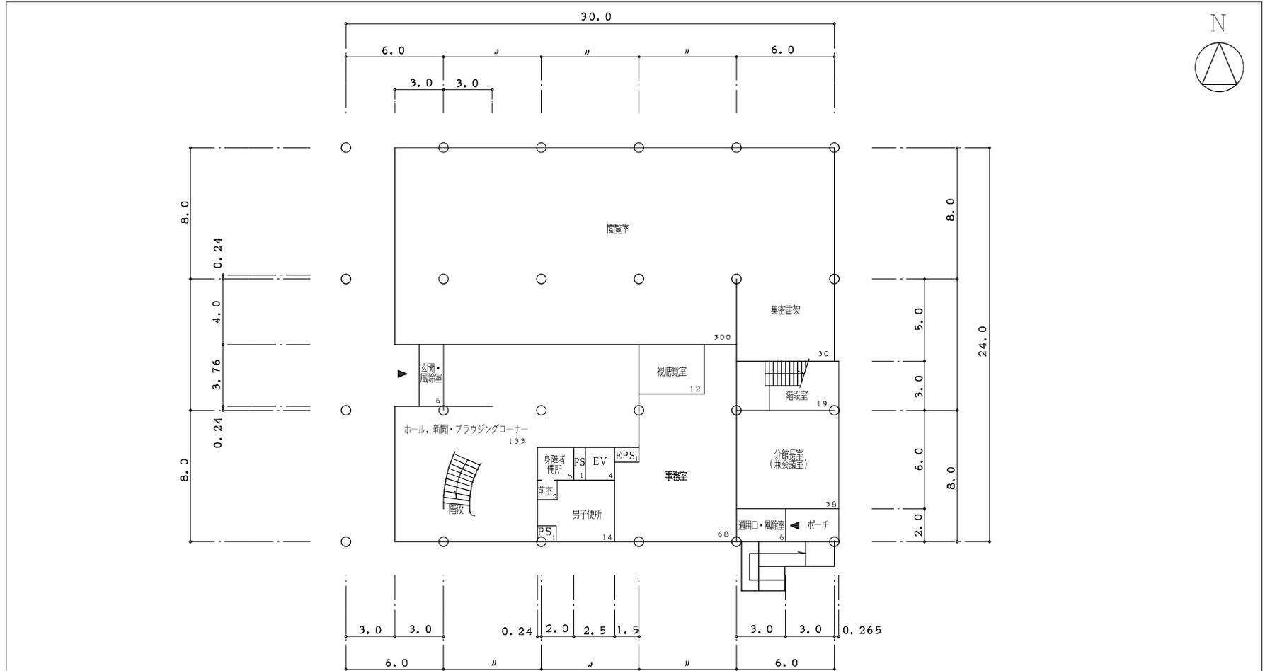
1階平面図 S=1/300 床面積 640㎡
