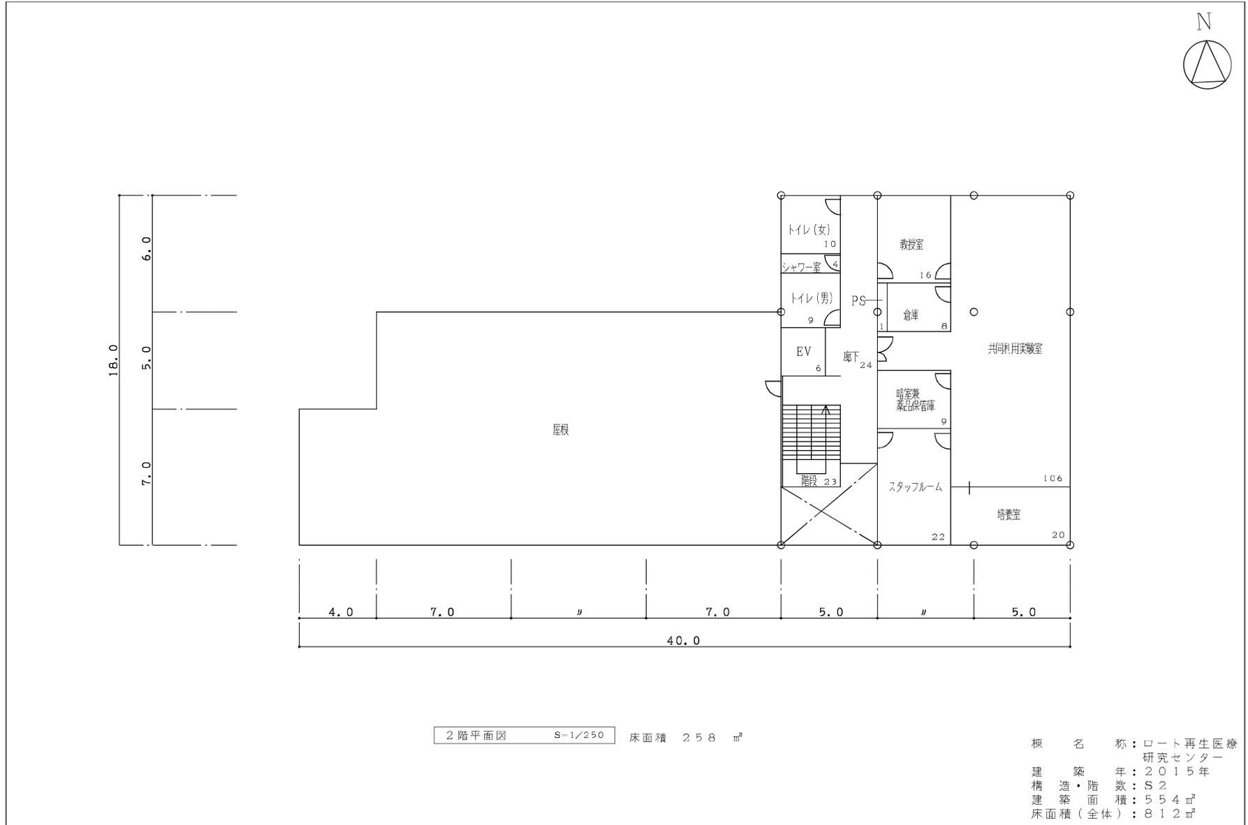
2階平面図 8-1/250 床面積 258 m<sup>2</sup>
