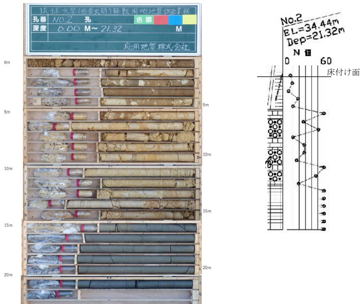
図 5.2.5 No.2 孔のボーリング結果整理図
