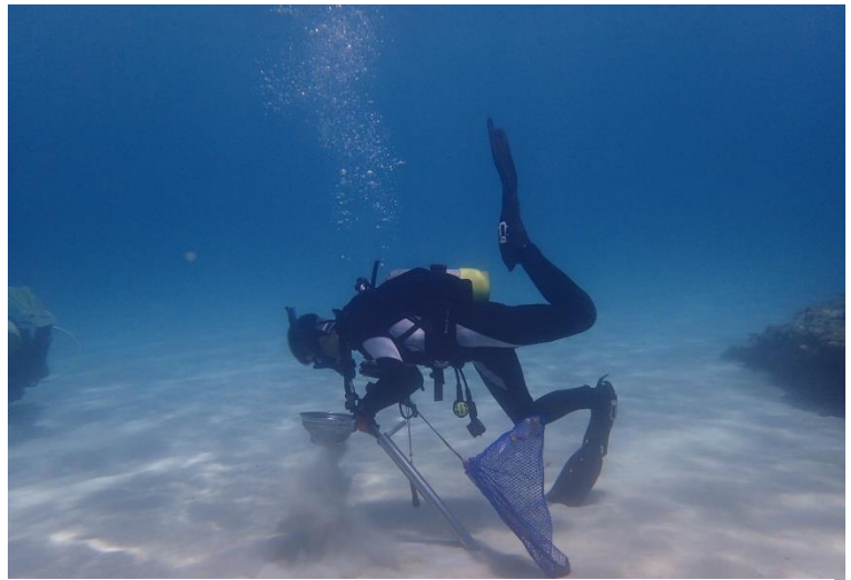
図1. 銀色の筒状のものがヤビーポンプ。写真は吸い上げたものをザルで濾しているところ。
