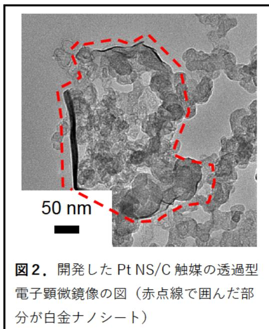
図 2. 開発した Pt NS/C 触媒の透過型電子顕微鏡像の図（赤点線で囲んだ部分が白金ナノシート）
