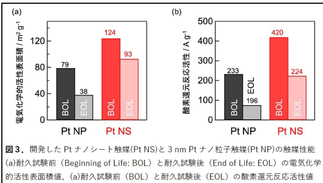
図 3. 開発した Pt ナノシート触媒(Pt NS)と 3 nm Pt ナノ粒子触媒(Pt NP)の触媒性能 (a)耐久試験前 (Beginning of Life: BOL) と耐久試験後 (End of Life: EOL) の電気化学的活性表面積値、(b)耐久試験前 (BOL) と耐久試験後 (EOL) の酸素還元反応活性値
