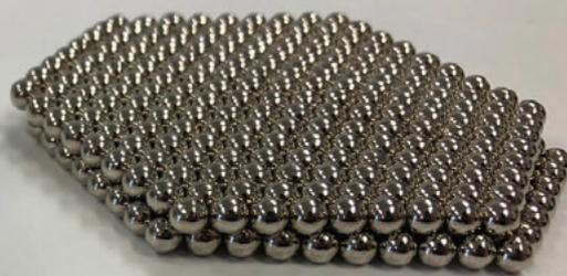
銀色の球一つ一つがPt原子。ナノ粒子では、Pt原子の40%程度しか、最外層に露出していない（Pt利用率が低い）。一方、**ナノシートは全Pt原子が露出しているため**、これまでのナノ材料では到達しえないPt利用率の実現可能性がある。
