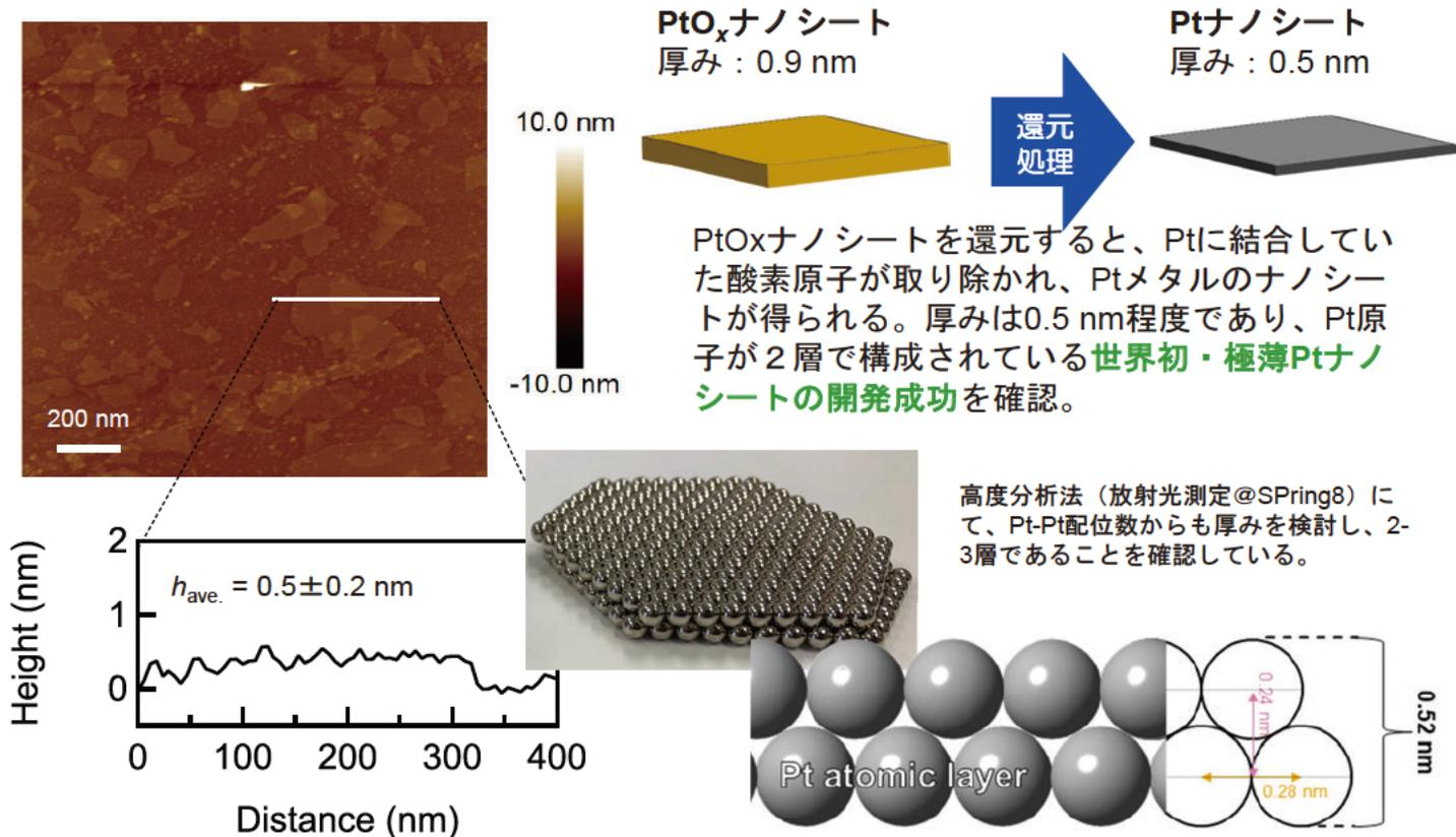
還元処理の条件を調整することで、開発したPtナノシートの厚みが増加していくことがわかっている。この現象を利用することで、ナノシートの厚みが結晶構造や触媒性能に対してどのような相関関係があるか明らかにでき、物理的視点に基づいた材料研究を進められる可能性があり、今後の検討課題として位置付けている。
