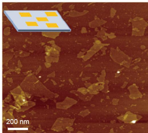
単層Ptナノシートの合成の肝となる単層PtOxナノシートの合成に成功。**一枚の厚みは約0.9 nm**であり、白金原子の周りに酸素が結合している結晶構造である。
