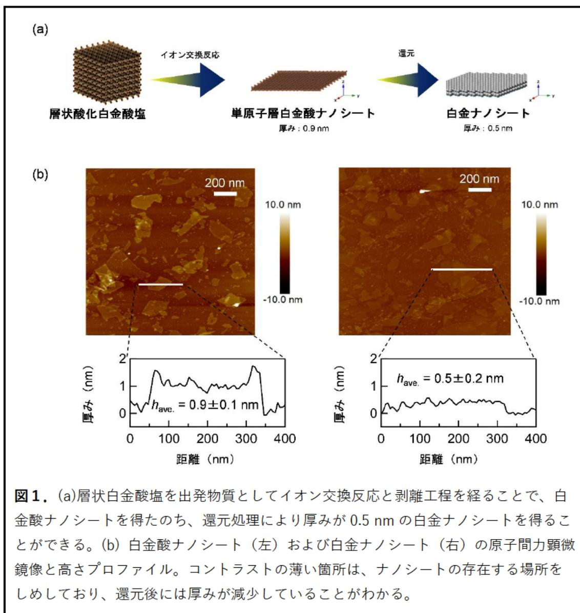
図1. (a)層状白金酸塩を出発物質としてイオン交換反応と剥離工程を経ることで、白金酸ナノシートを得たのち、還元処理により厚みが0.5 nmの白金ナノシートを得ることができる。(b)白金酸ナノシート(左)および白金ナノシート(右)の原子間力顕微鏡像と高さプロファイル。コントラストの薄い箇所は、ナノシートの存在する場所をしめしており、還元後には厚みが減少していることがわかる。
