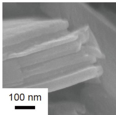
層状化合物の走査型電子顕微鏡像。**層状構造の物質**であることがわかる。これを一枚一枚剥離することでPtOxナノシートを得られる。
