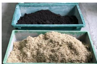
(a) バガス灰(上)，バガス(下)
