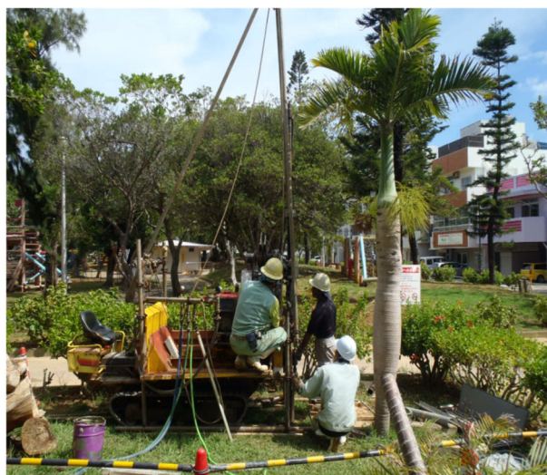
図1. 那覇市若狭公園でのサンゴ礁堆積物の掘削風景
