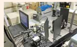
▲フェムト秒レーザを用いた超広帯域光源発生実験
