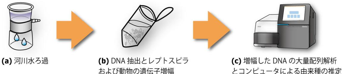
図1. レプトスピラDNA検出法の概要。(a) 500 mL の河川水をろ過して懸濁物を濃縮。(b) 紙からDNAを抽出し、レプトスピラが保有する *lipL32* と 16S rRNA 遺伝子、動物のミトコンドリアDNAが保有する 12S rRNA 遺伝子、細菌全般が保有する 16S rRNA-V4 遺伝子をターゲットとしたPCR増幅を行う。(c) 増幅したDNAを次世代シークエンサーで大量配列決定し、大型コンピュータで解析することで、配列が由来する生物(レプトスピラ、動物、細菌の種)を特定。
