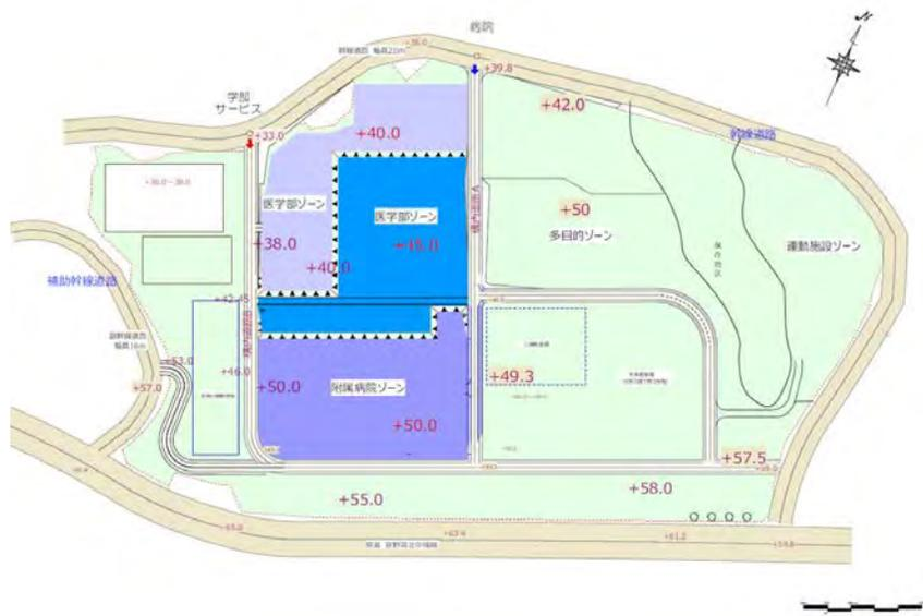
全体的に北西方向に傾斜敷地の敷地形状を活かして、大規模施設となる、附属病院・研究棟・講義実習棟等を配置する宅盤を段状に計画することにより、敷地に対する土木工事量の低減化を図った計画とする。
