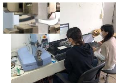
(b) バガスの引張試験
