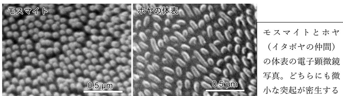
**幼生の付着を抑制するモスアイ構造** 琉球大学理学部海洋自然科学科の広瀬教授と同大学院医学研究科の泉水助教は多数のホヤ幼生が泳ぐ容器にモスアイ構造フィルムと無構造フィルムを同時に浮かべ、幼生がどちらのフィルムを選択して付着・変態するかを調べました。合計 8 回の実験を行った結果、フィルムの表面に付着したホヤ幼生の数は常にモスアイ構造の方が少ないことが明らかになりました ( $P < 0.01$ , paired  $t$ -test)。これは、モスアイ構造が幼生の付着を抑制する機能を持つことを示しています。
