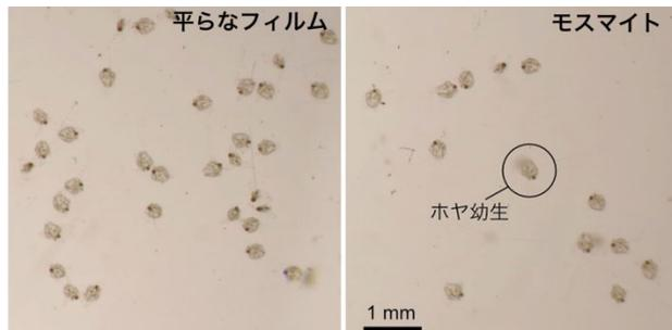
平らなフィルム上には 33 の幼生が付着しているのに対して、モスアイ構造フィルム上には 13 の幼生が付着している。
