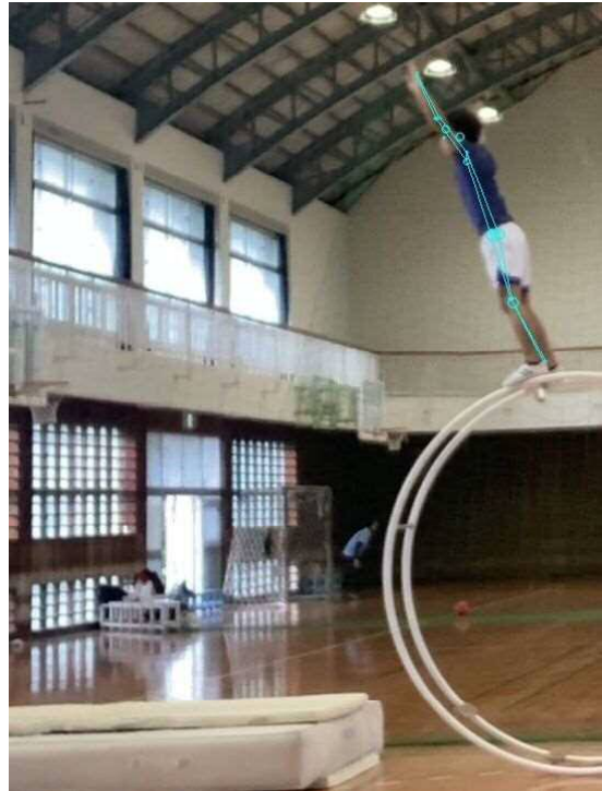
図2：AI（Posenet）によるラート競技者の演技中の姿勢推定（2019/08/19 第一体育館）。 ※ Posenetは動画像のみ（センサ等は不使用）からそこに映った人物の目鼻、肩や腰、膝の位置を推定（図中では青丸点として表示）するディープラーニング。この技術により、今まで感覚的に行っていた動作を具体的な数値として可視化できる。
