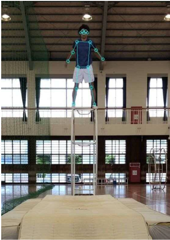
図2：AI（Posenet）によるラート競技者の演技中の姿勢推定（2019/08/19 第一体育館）。 ※ Posenetは動画像のみ（センサ等は不使用）からそこに映った人物の目鼻、肩や腰、膝の位置を推定（図中では青丸点として表示）するディープラーニング。この技術により、今まで感覚的に行っていた動作を具体的な数値として可視化できる。
