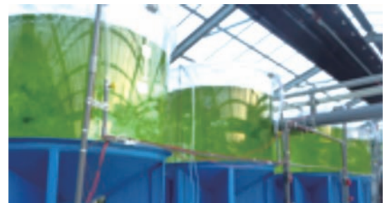
写真1 高濃度二酸化炭素溶解海水による海藻の培養
